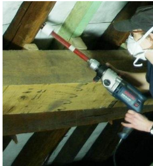
Fig. 8. Voorbeeld van bemonstering in de vorm van een boorkern met behulp van een kernboor van 23 mm diameter bevestigd op een elektrische boormachine. © KIK-IRPA, Brussel, werkfoto
