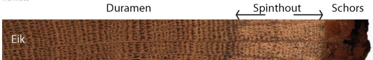
Fig. 17. Dwarsdoorsnede van een monster van eik dat de verschillende anatomische structuren toont, in het bijzonder het duramen en het spinhout. © KIK-IRPA, Brussel, werkfoto
